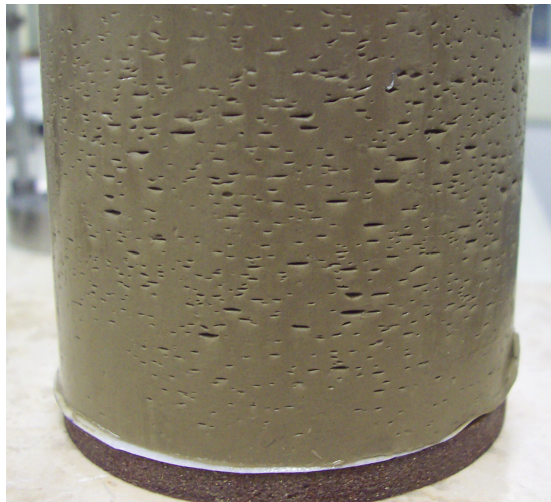
Fig. 5.1 Materiale a fine consolidazione a seguito di un errato metodo di realizzazione
