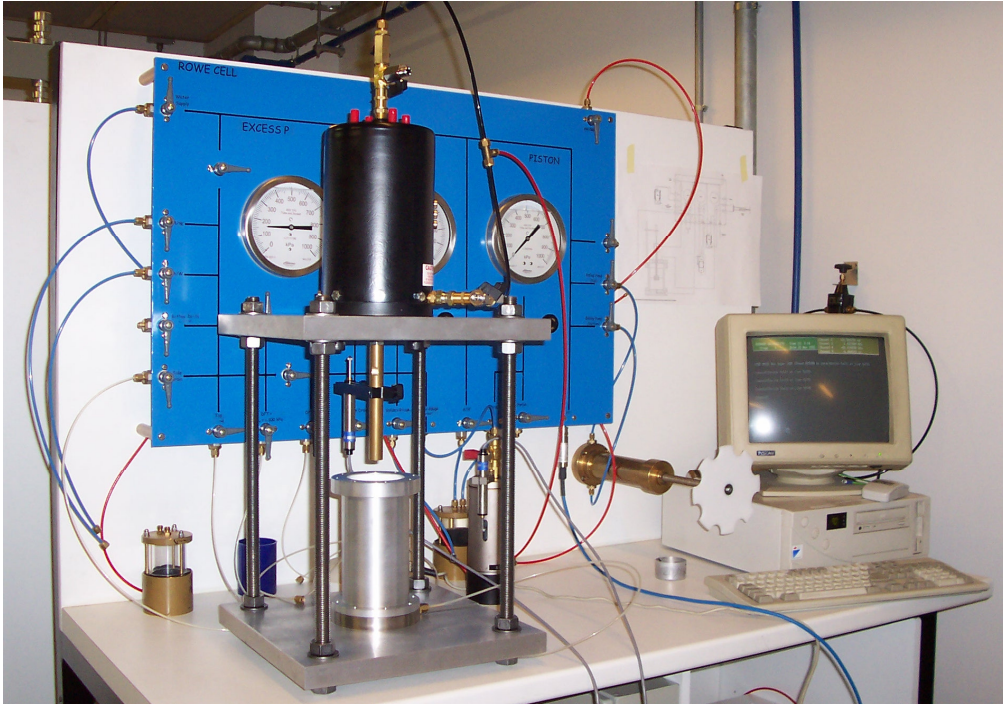
Fig. { STYLEREF 1 \s }, { SEQ Fig. \* ARABIC \s 1 } Consolidometro e impianto di pressioni
