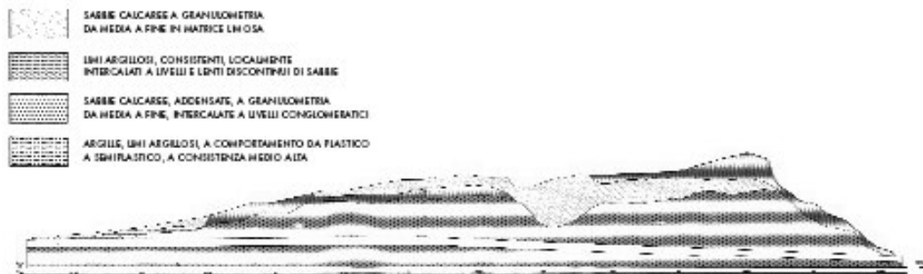
Fig. 3.4 Tracciato della galleria di Vasto (Rapporto RFI, 2005)
