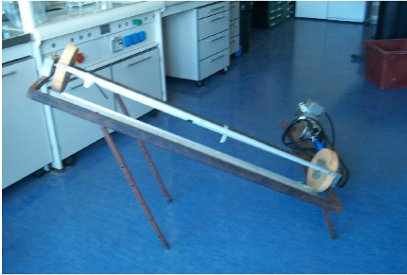
Foto 2.1: macchina rotante utilizzata per garantire la miscelazione dei bioslurry
