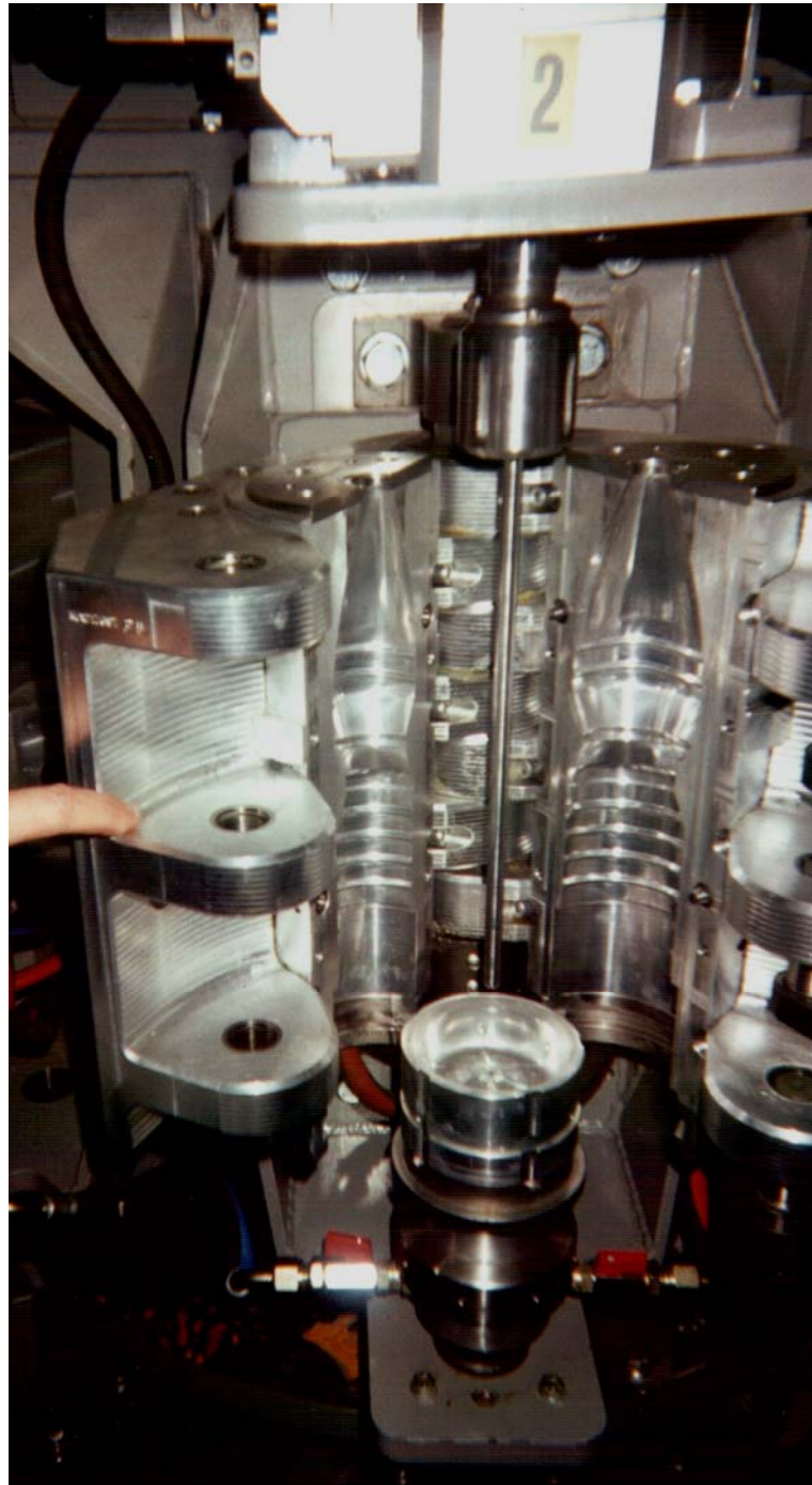
Fig. 3.5 - Stampo che rappresenta in negativo la forma finale della bottiglia.
