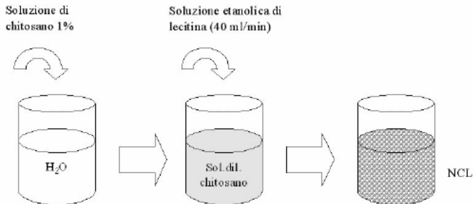
FIG. 5 schema del metodo utilizzato per la produzione delle NLC
