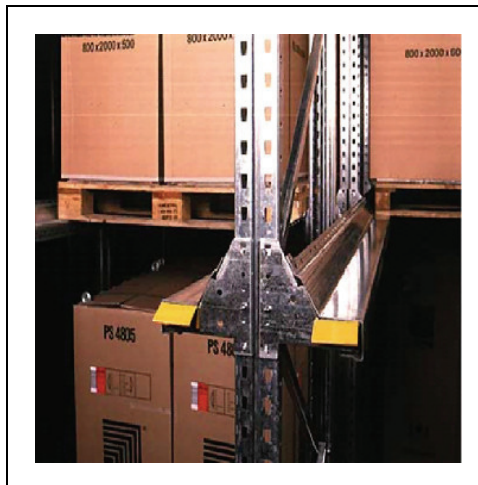
Figura 22 – Guide di sostegno per lo stoccaggio di udc palletizzate in scaffalature drive-in .
