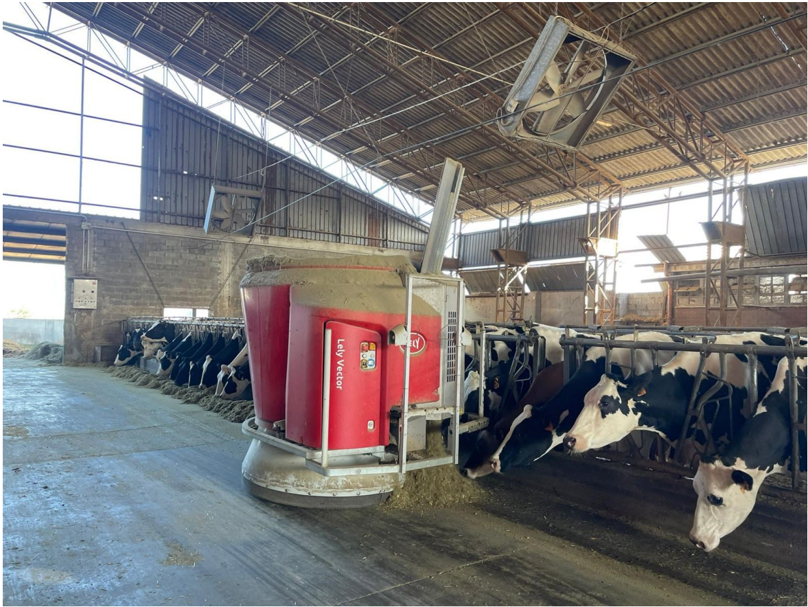
Figura 14: Sistema di distribuzione degli alimenti alla mangiatoia presso l'azienda Benassi
