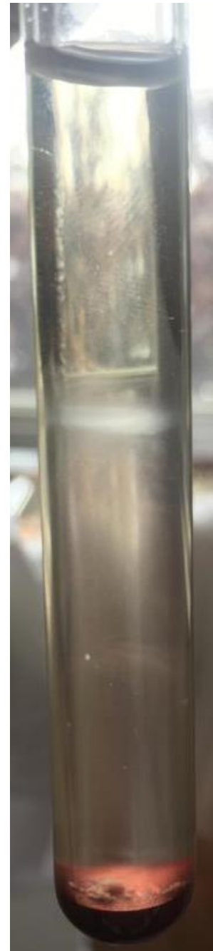
Figura 14 provetta post centrifugazione. Si nota l'anello bianco dei leucociti.
