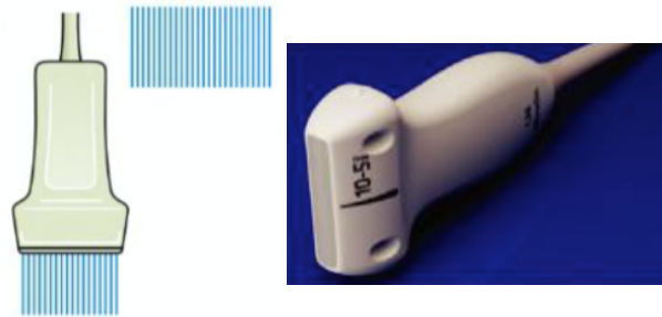
Figura 7. Sonda lineare e la sua area di scansione rettangolare. (Soni et al., 2015)
