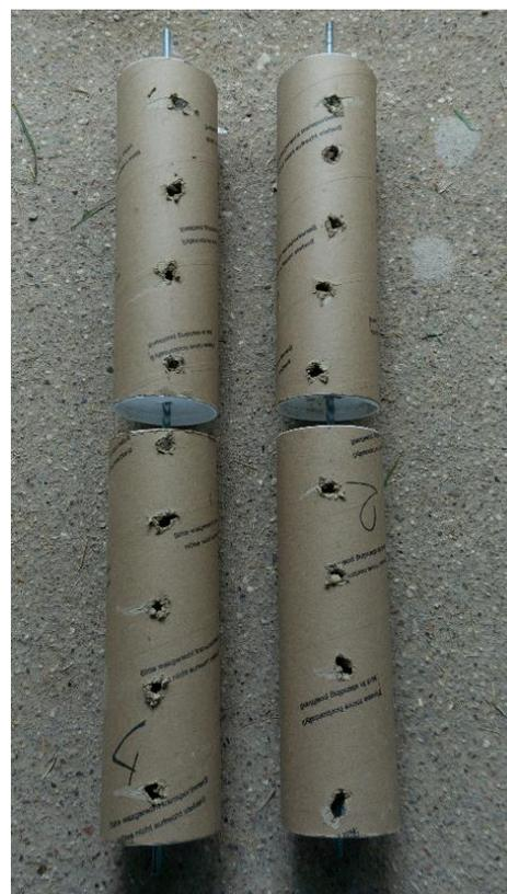
**Figura 4.3:** Cilindri utilizzati per l'esperimento, sui quali sono stati eseguiti 9 buchi per coppia.
