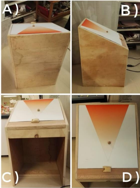
Figura 1: Strumento di misurazione, foto scattata durante l'esperimento. Lo strumento è alto circa un metro. La superficie rettangolare ha una misura pari a 45 cm x 50 cm; le misure del triangolo isoscele disegnato all'interno corrispondono a 35 cm della base e a 45 cm dell'altezza. In a) è visibile la parte posteriore dello strumento, in b) è presente la porzione laterale e in c) frontale; in d) è possibile vedere la superficie sulla quale è disegnato il triangolo.
