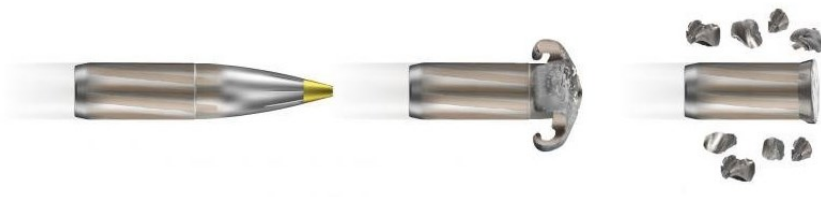
Figura 11: Esempio di proiettile in stagno alimentare (RWS 9.3x62 EVO green) e relativa frammentazione (per gentile concessione di Jacopo Pellini, armaiolo).
