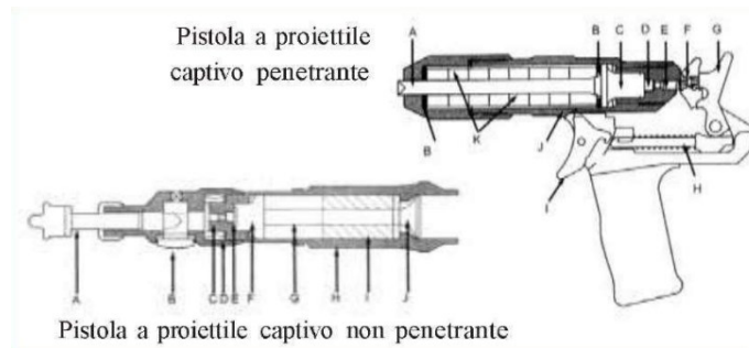
Figura 62: Rappresentazione schematica dei due tipi di pistola a proiettile captivo, penetrante e non penetrante (Martinelli, 2016).
