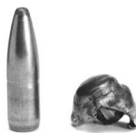
Figura 34: Proiettile semi-incamiciato ( semi-jacketed ) calibro 7.62x51 (308 Win.) prima e dopo la deformazione (Kneubuehl et al. , 2011).
