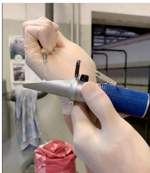
Figura 18 Esecuzione dell'analisi mediante rifrattometro: l'operatore ha appena posto una goccia di colostro sul prisma dello strumento. (Foto personale).
