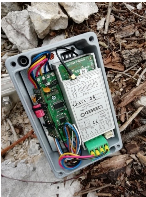
Figura 3.4 All'interno del modulo BPM sono poste le schede elettroniche necessarie per l'acquisizione dei dati dal sensore MEMS e dall'ampolla elettrolitica e la periferica radio slave funzionale alla comunicazione dei dati al sistema.
