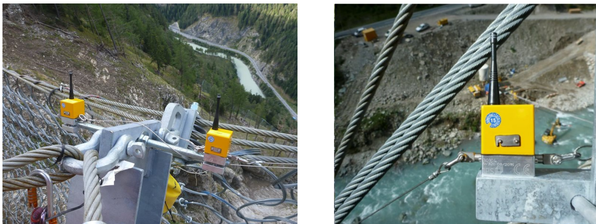
Figura 2.5 Dispositivo di misura realizzato dalla società Geoprevent installato su di una barriera paramassi.
