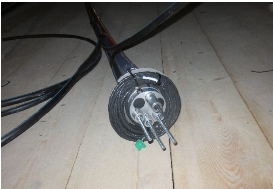
Figura 2.2 a) Testa di un estensimetro multibase in cui sono collegate tre basi. Nella fase operativa la barra filettata passante per il foro viene collegata al comparatore elettrico b) Estensimetro elettrico a controllo dell'apertura di una discontinuità.
