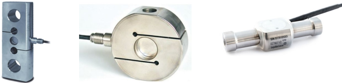
Figura 3.13 Esempi di celle di carico a trazione. I primi due modelli consentono di effettuare misure di carico di piccola entità grazie agli intagli presenti nella struttura che ne favoriscono la deformazione.
