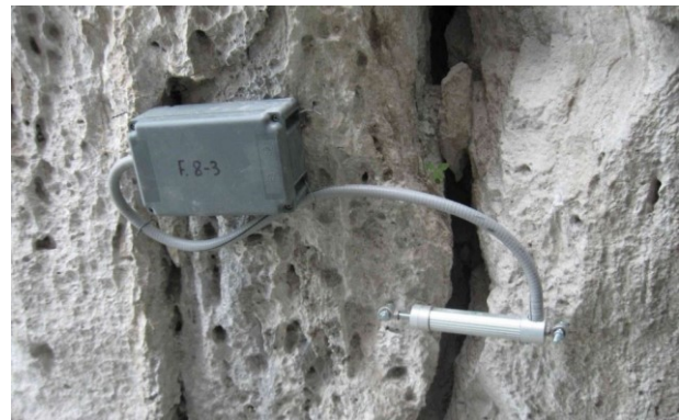
Figura 2.2 a) Testa di un estensimetro multibase in cui sono collegate tre basi. Nella fase operativa la barra filettata passante per il foro viene collegata al comparatore elettrico b) Estensimetro elettrico a controllo dell'apertura di una discontinuità.
