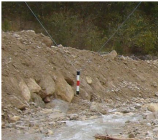
Figura 2.15 Un pendolo installato nel torrente Rotolon in Italia (Cavalli et al., 2013).
