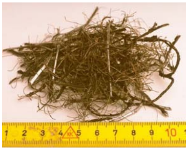
Metalli estratti dai pneumatici
