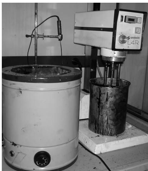
Figura 6-8: Strumento utilizzato per l’agitazione della miscela bitume-polimero
