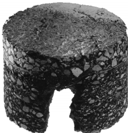
Figura 3-19: Carote che mostrano le capacità di resistenza alla fessurazione degli strati in Asphalt Rubber
