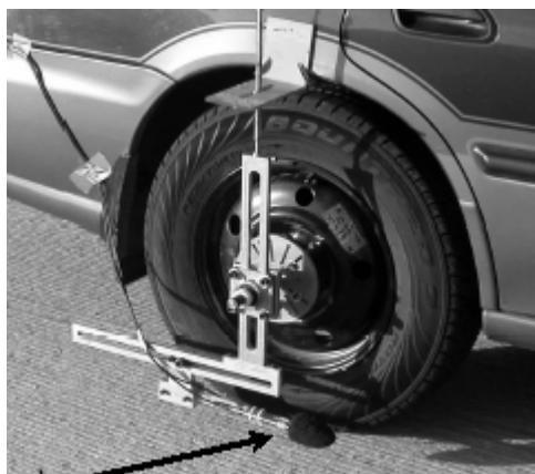
Figura 3-27: Strumentazione di misura dell'intensità sonora (SI) montata sulla ruota destra di un autoveicolo
