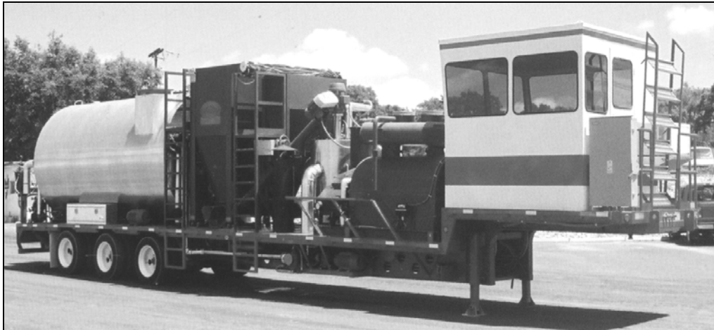
Figura 3-34: Esempio di impianto mobile per la produzione di Asphalt Rubber
