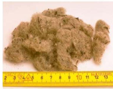
Fibre estratte dai pneumatici
