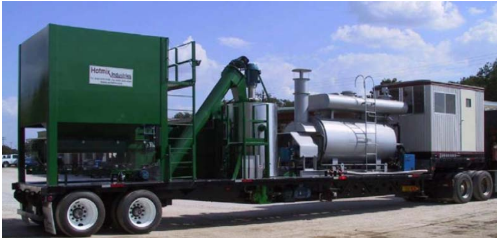
Figura 2-10: Esempio di impianto per la produzione di Asphalt Rubber
