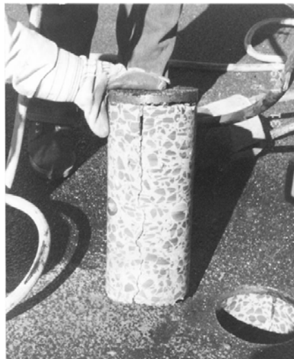
Figura 3-19: Carote che mostrano le capacità di resistenza alla fessurazione degli strati in Asphalt Rubber
