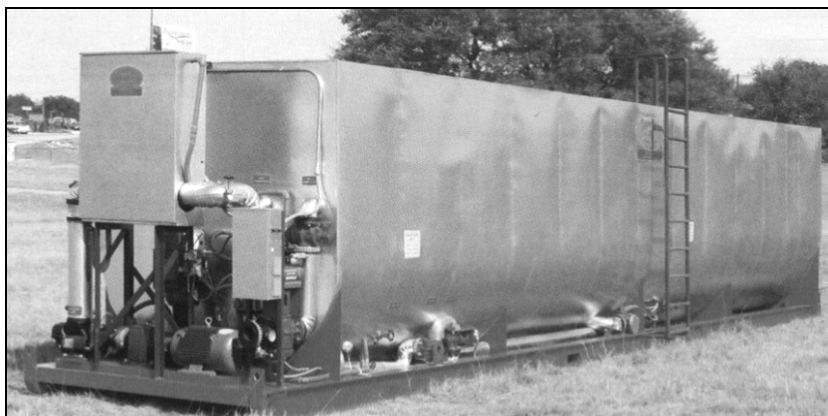
Figura 3-46: Serbatoio di reazione del legante AR
