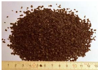
Polverino di gomma dopo la fase finale del processo di riciclaggio
