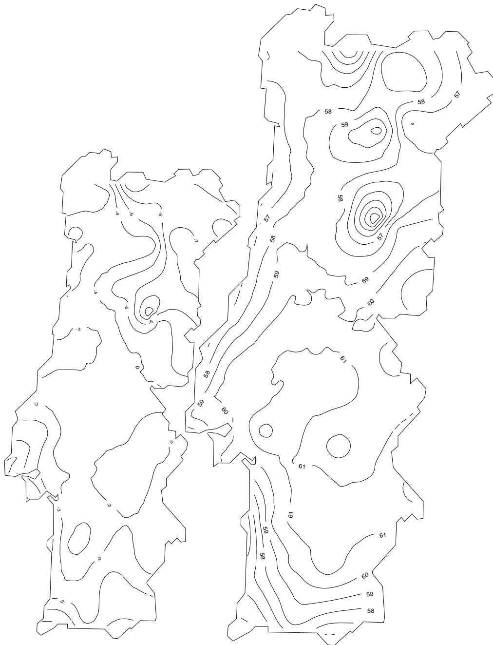
Figura 3: Rappresentazione spaziale delle temperature di progetto massima e minima per la definizione del Grado PG.
