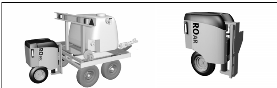
Figura 3-8: Esempio di veicolo per la misura del coefficiente di aderenza trasversale (CAT)
