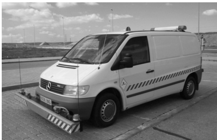
Figura 3-7: Esempio di profilometro laser
