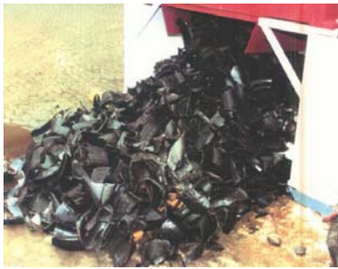
Pneumatici dopo la prima fase di triturazione
