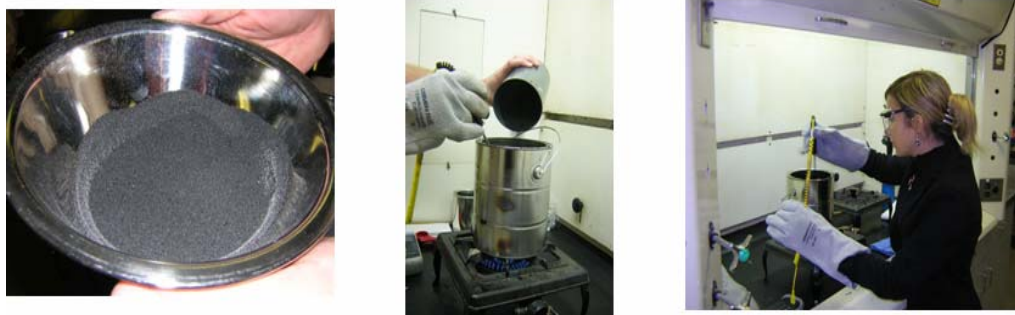
Figura 6-6: Fasi di produzione in laboratorio di un bitume modificato con polverino di gomma di pneumatico riciclata
