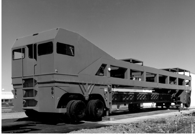
Figura 3-11: Heavy Vehicle Simulator impiegato per lo studio del Caltrans e del CSIR.
