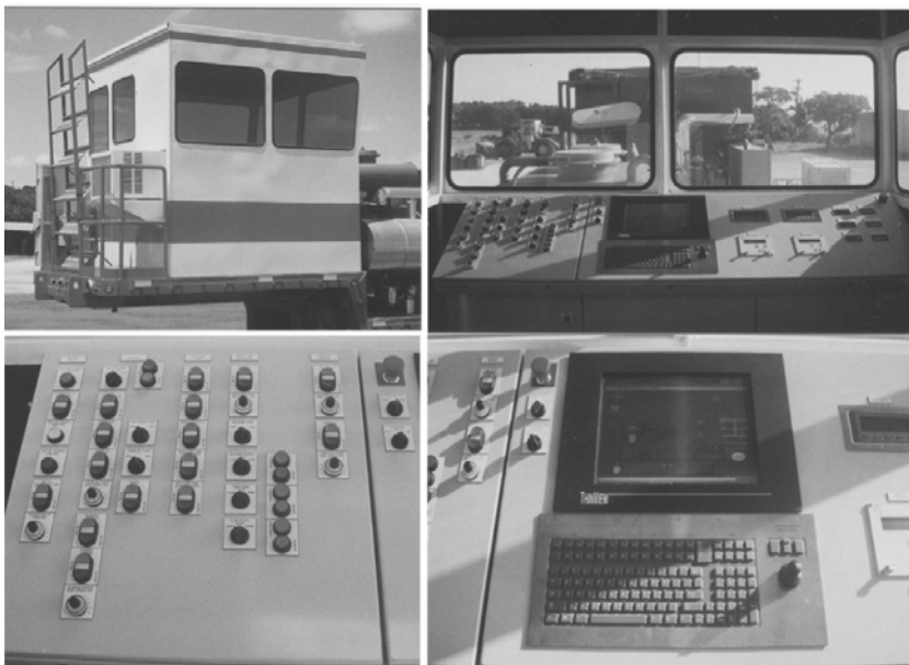
Figura 3-47: Cabina di controllo dei vari parametri del processo di produzione dell'Asphalt Rubber
