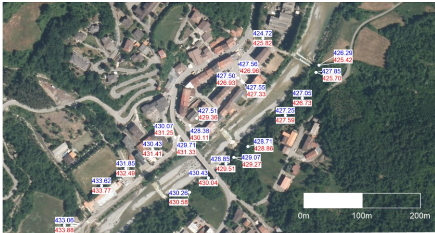
Figura 4.34: Quote idriche massime rilevate (in rosso) e calcolate (in blu) nell'intorno dell'abitato di Farini
