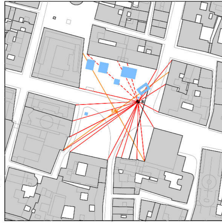
STAZIONE DI COLLIMAZIONE (S1, S2) STAZIONE IDEALE (S3) IMPEDIMENTI VISIVISICI ALLA COLLIMAZIONE (aerocivi commerciali temporanei) RAGGI DI COLLIMAZIONE
