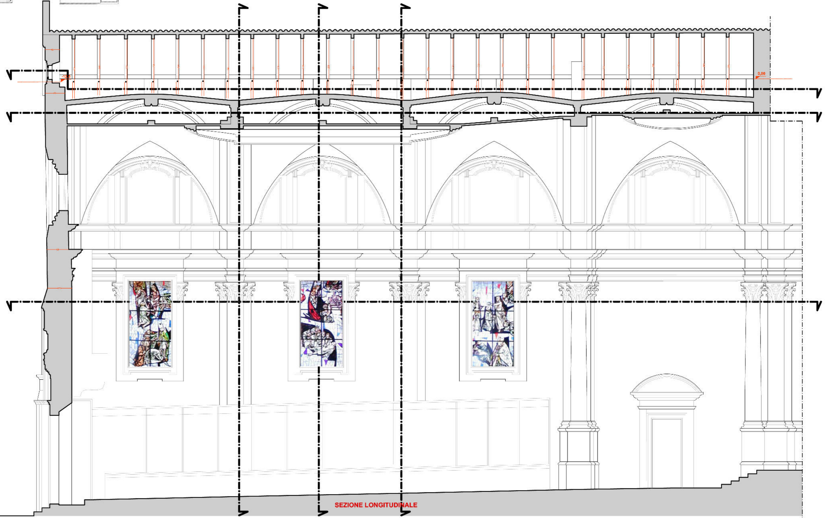
TAV. 1.4 FORMA E DEFORMAZIONE: LE VOLTE DELLA CHIESA DELL'ABBAZIA DI MONTEOLIVETO
