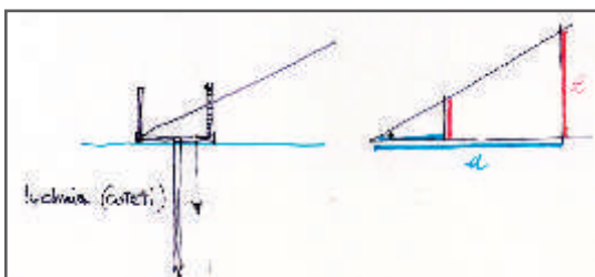
Lychnia: misurazione di distanze
