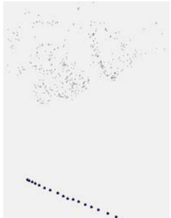
Figura 1.30: Posizioni di presa e punti restituiti utilizzando le 17 immagini della sequenza realizzata nel sito di Arnad.
