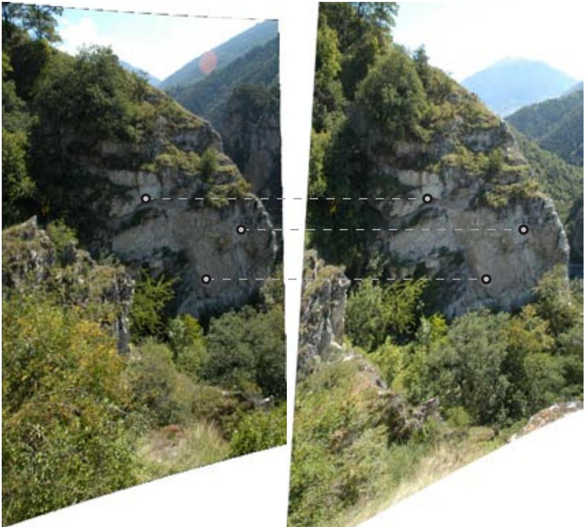
Figura 2.8: Generazione di immagini epipolari con il metodo proiettivo.
