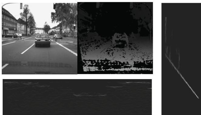
Figura 1.5: Sono mostrate in figura come descritto in [1] l'immagine acquisita (in alto a sinistra) con la corrispondente mappa di disparità (in alto al centro). La V-Disparity sulla destra, mostra il profilo stradale mentre la U-Disparity in basso evidenzia gli ostacoli.
