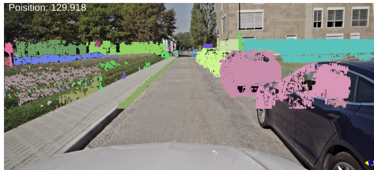
Figura 4.6: È raffigurata rilevazione di un pedone alto 1,70m e un cestino della carta alto 1,10m.
