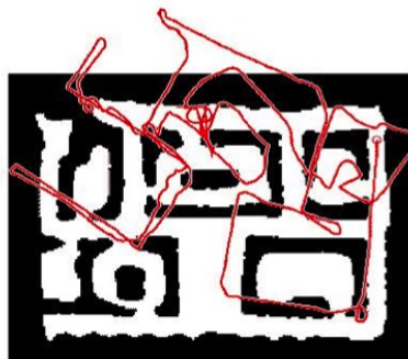
Figura 1.1: La figura mostra l'errore commesso dal robot durante la navigazione, sovrapponendo il percorso effettuato (rosso) con la mappa.
