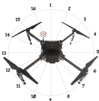
Figura 3.7: Mostra come l'angolo imbardata ( yaw ) del drone sia stato quantizzato 16 sezioni.
