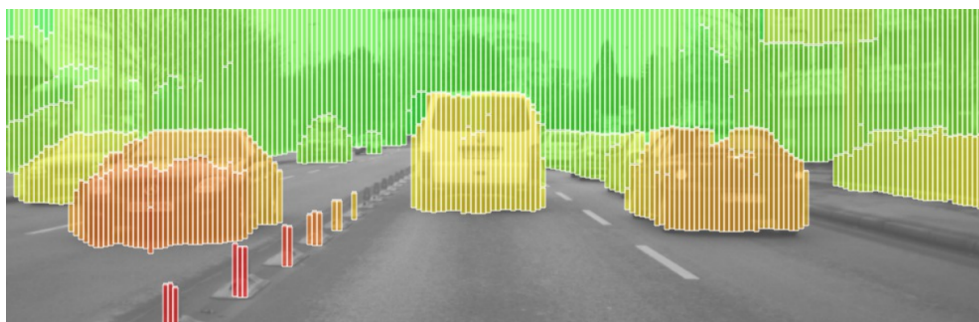
Figura 1.6: Descrive gli Stixel calcolati come descritto in [2], il colore rappresenta la distanza dell'ostacolo (rosso oggetti vicini e verde oggetti lontani).
