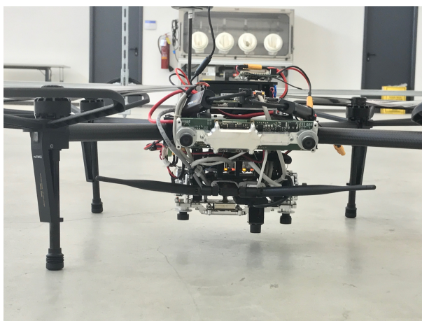
Figura 3.3: Vista frontale del drone allestito con i due 3DV-E.
