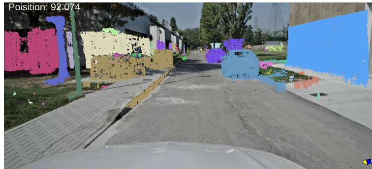
Figura 4.4: É raffigurata la distanza massima a cui sono visibili i coni stradali alti 30cm.
