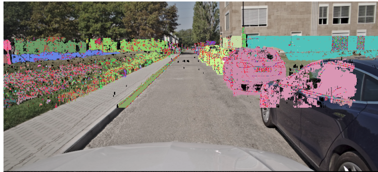
Figura 4.8: Sono raffigurati i cluster validati con le feature (punti rossi), è possibile notare come i cluster neri vengano eliminati, poiché privi di feature.
