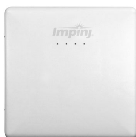
Figura 2.4: Il gateway RFID "xArray" di Impinj
