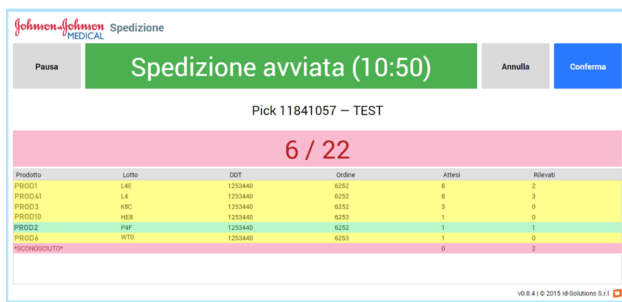
Figura 4.6: La lettura RFID durante il processo di Spedizione effettuato tramite client web e Smart Table
