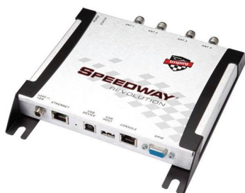
Figura 2.1: Il reader RFID fisso "Speedway Revolution" di Impinj (versione a 4 antenne)
