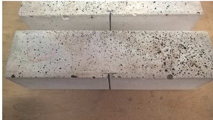
Figura 3.7 Intaglio realizzato nei provini da sottoporre a flessione
