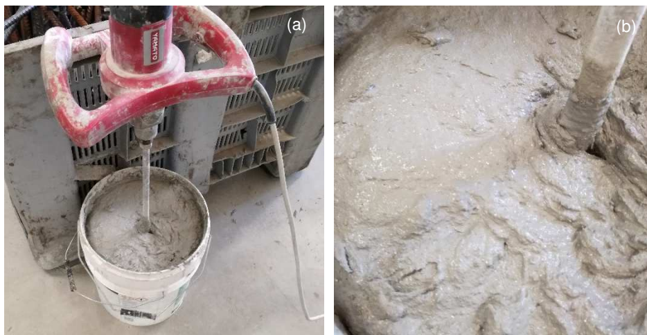
Figura 3.5 Miscelazione del composto mediante miscelatore meccanico
