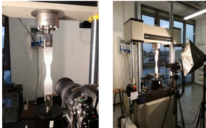
Figura 3.20 Posizione della macchina fotografica utilizzata per l'acquisizione delle immagini (a) e illuminatore (b)
