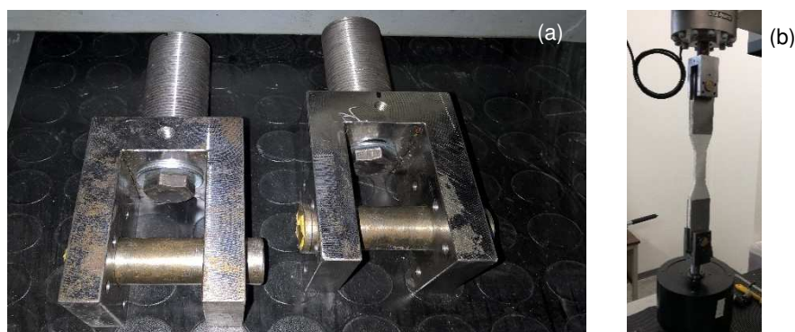
Figura 3.27 Sistemi di aggancio utilizzati per le prove a trazioni (a) e sistema complessivo in uso
