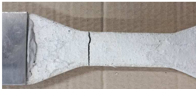
Figura 3.30 Esempio di provino a osso di cane fessurato dopo la rastremazione
