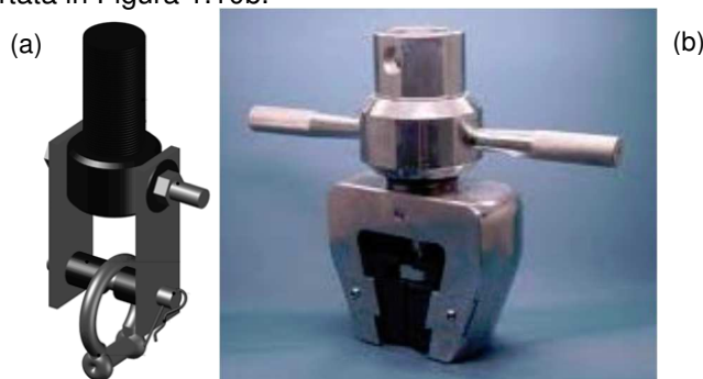
Figura 1.9 Modalità di aggancio del provino per la caratterizzazione del comportamento a trazione: tipo Clevis (a) e Grip (b) [8,9]
