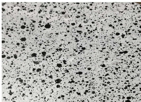
Figura 3.18 Particolare del pattern puntinato creato sulle superficie che saranno analizzate con la tecnica DIC
