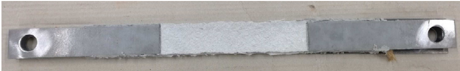
Figura 3.11 Provini FRCM a cui sono incollate le piastrine d'acciaio
