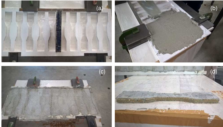
Figura 3.2 Casseri in POLIPLAT (a), riempimento casseri (b), maturazione (c), provino scasserato (d)
