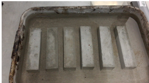
Figura 3.6 Maturazione in acqua dei provini a flessione.
