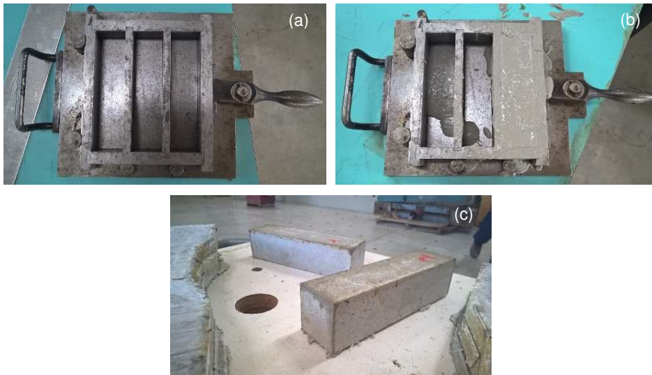
Figura 3.4 Casseri per i provini a flessione (a), riempimento casseri (b) e prismi da testare a flessione
