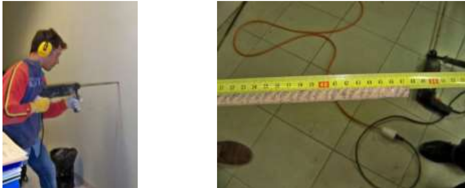
Figura 5.1 – Verifica di alcuni spessori murari tramite esecuzione a campione di fori col trapano.
