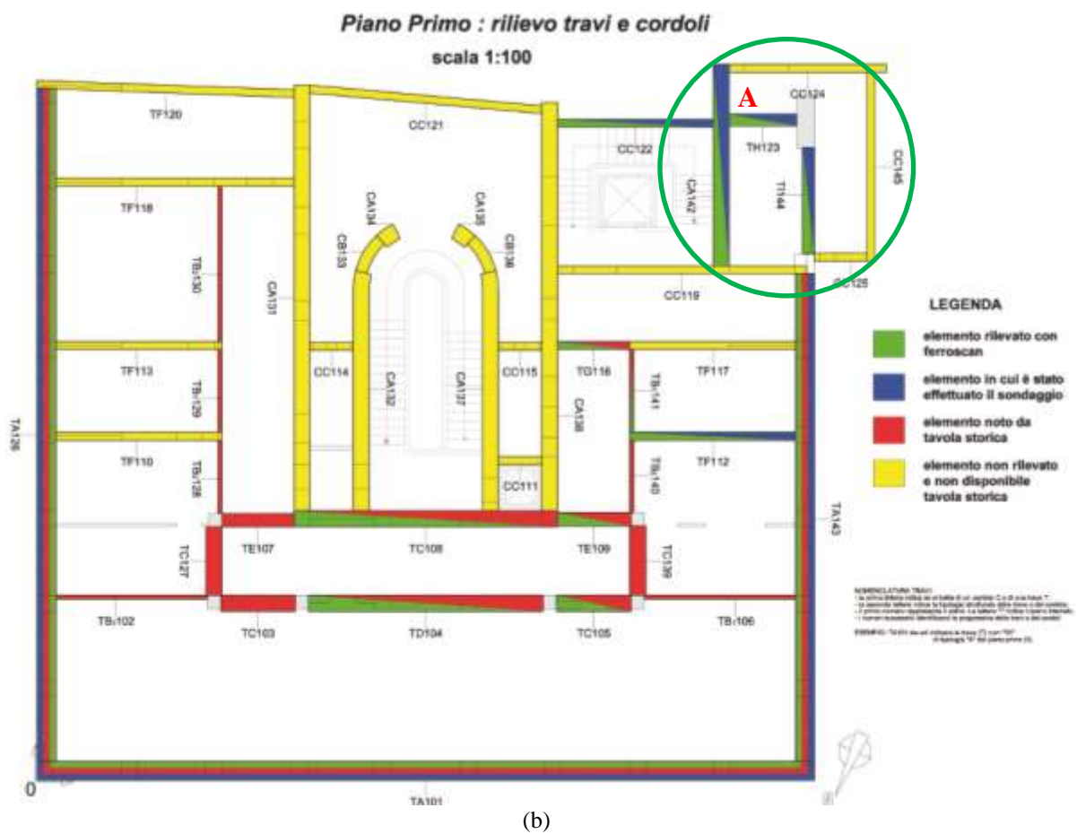
Figura 5.66 – (a) Estratto del progetto esecutivo del 1937, con indicazione in pianta delle travi al piano primo; (b) pianta con indicazione della nomenclatura adottata per le travi del piano primo.
