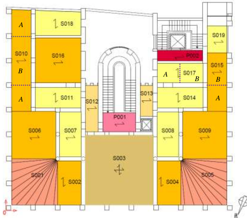
Figura 6.11 – Pianta chiave dei solai, primo orizzontamento.
