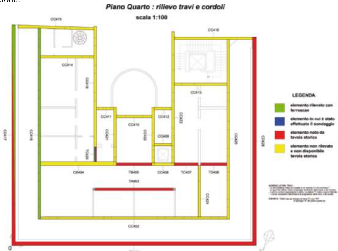
Figura 5.83 – Pianta con indicazione della nomenclatura adottata per le travi del piano quarto.
