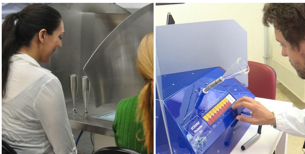
Figura 2.6 - Differenti tipologie di porte di annusamento in un olfattometro
