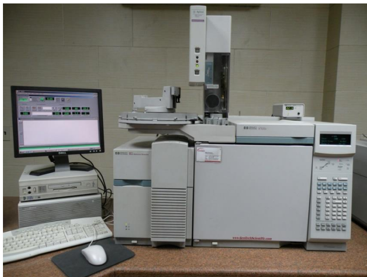
Figura 4.1 - Gascromatografo HP 6890 Series Plus e spettrometro di massa MSD 5973 (Agilent Technologies)
