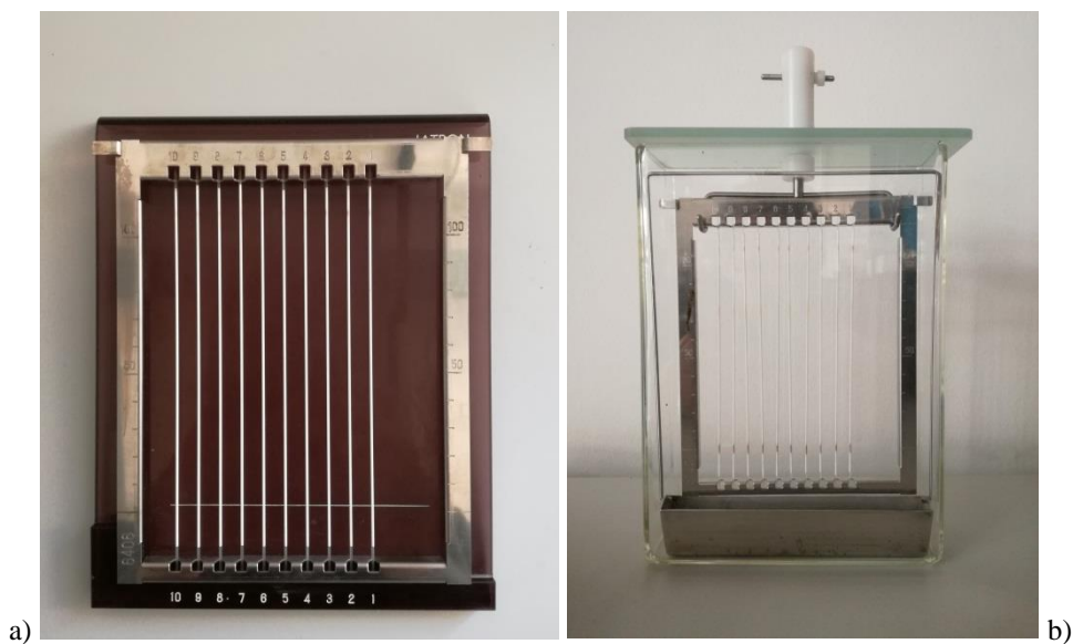
Figura 3.12 - Rastrelliera con i 10 chromarods (a) e camera di sviluppo (b)
