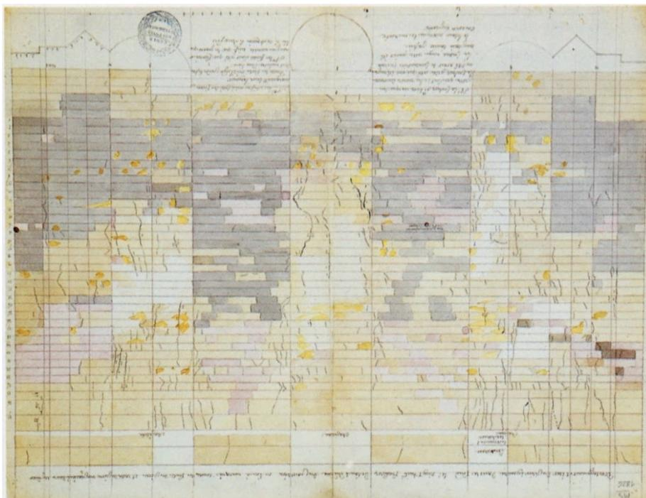
*Figura 12 L'attento rilievo del quadro fessurativo lungo il perimetro di un pilone del Panthéon (Archives Nationales, 56AJ/6, foto di Carlo Blasi) è stato fondamentale nella comprensione delle cause del danneggiamento e nella conseguente definizione dell'intervento riparatore.*
