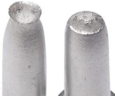
Figura 1.7 Morfologia frattura duttile: frattura a coppa e a cono.
