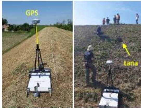
Fig. 10.19 Strumentazione georadar (GPR) munita di antenna GPS (Esplora S.r.l.).
