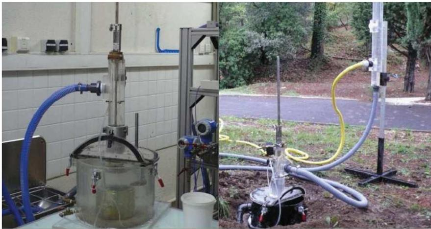
Fig. 5.6 Esempio di apparato sperimentale del *Jet Erosion Test* (JET) (da Mercier, 2014).
