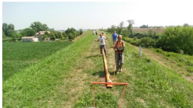
Fig. 10.20 Rilievo con strumento elettromagnetometro frequency domain (FDEM) (dotazione Esplora S.r.l.).
