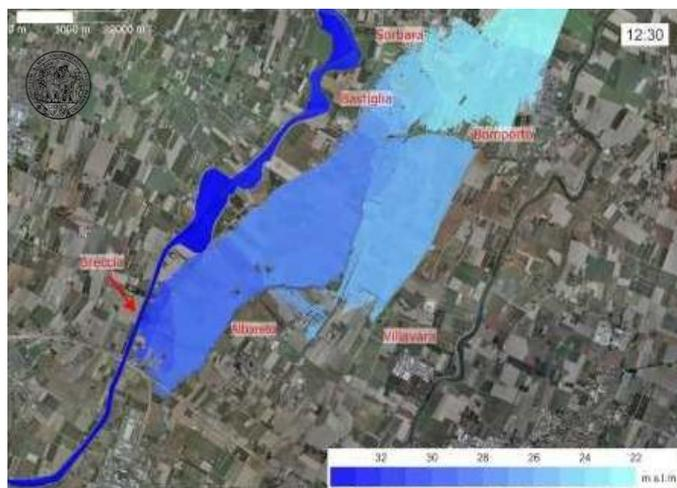
Fig. 4.4 Simulazione 48 ore dopo la rottura dell'argine del fiume Secchia del 19/01/2014, realizzata dall'Università degli studi di Parma (Vacondio et al., 2014).
