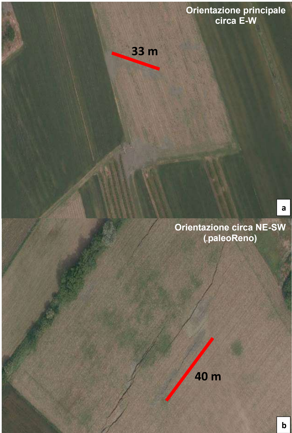
Fig. 5.6 – (a) Esempio di liquefazione connessa a fratturazione superficiale in località San Carlo. (b) Esempio di fratturazione superficiale in località San Carlo. Nelle immagini sono riportate le orientazioni generali, relative all'insieme dei fenomeni investigati (a) o per la sola zona del paleo Reno (b).
