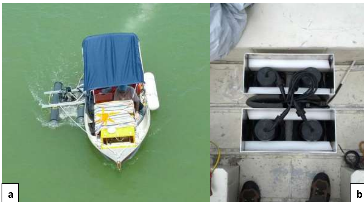
Fig. 4.5 – Configurazione di acquisizione con sub-bottom profiler. (a) Supporto dei trasduttori fissato al fianco dell'imbarcazione (da Priore et al, 2013). (b) Trasduttori collocati all'interno di box in alluminio fissati internamente all'imbarcazione. In entrambi i casi, la consolle di acquisizione dati (box giallo) è collocata a prua dell'imbarcazione.
