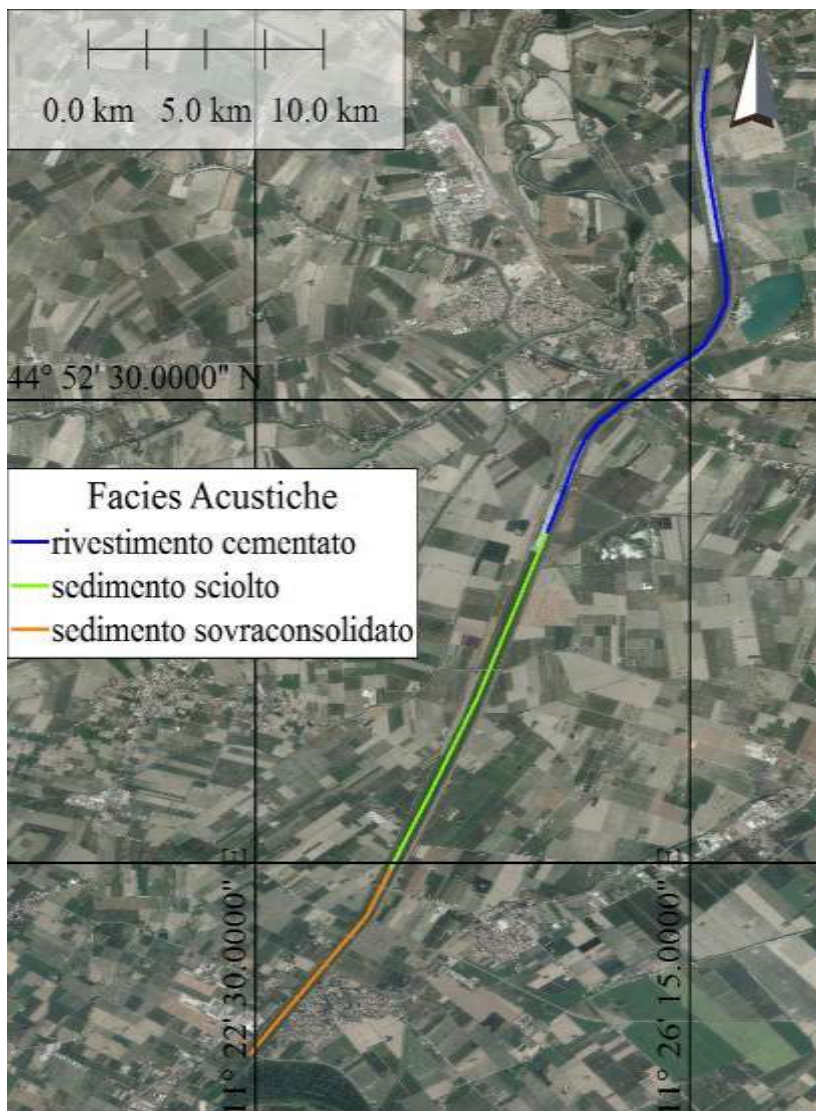
Fig. 4.9 – Classificazione della tipologia del fondo canale del Cavo Napoleonico (vedi legenda), come risultato dell'analisi di riflettività dei sedimenti (modificato da Priore et al, 2013).
