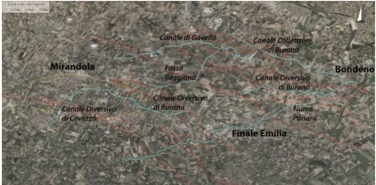
Fig. 4.15 – Mappa del progetto di rilievo lungo i canali del Consorzio di Bonifica di Burana e lungo il Fiume Panaro (in azzurro). In rosso, mappa strutturale d'Italia (da Bigi et al, 1992). In giallo, zona di massimo sollevamento a seguito del sisma del 29 Maggio 2012 (da CNR-IREA, 2012).
