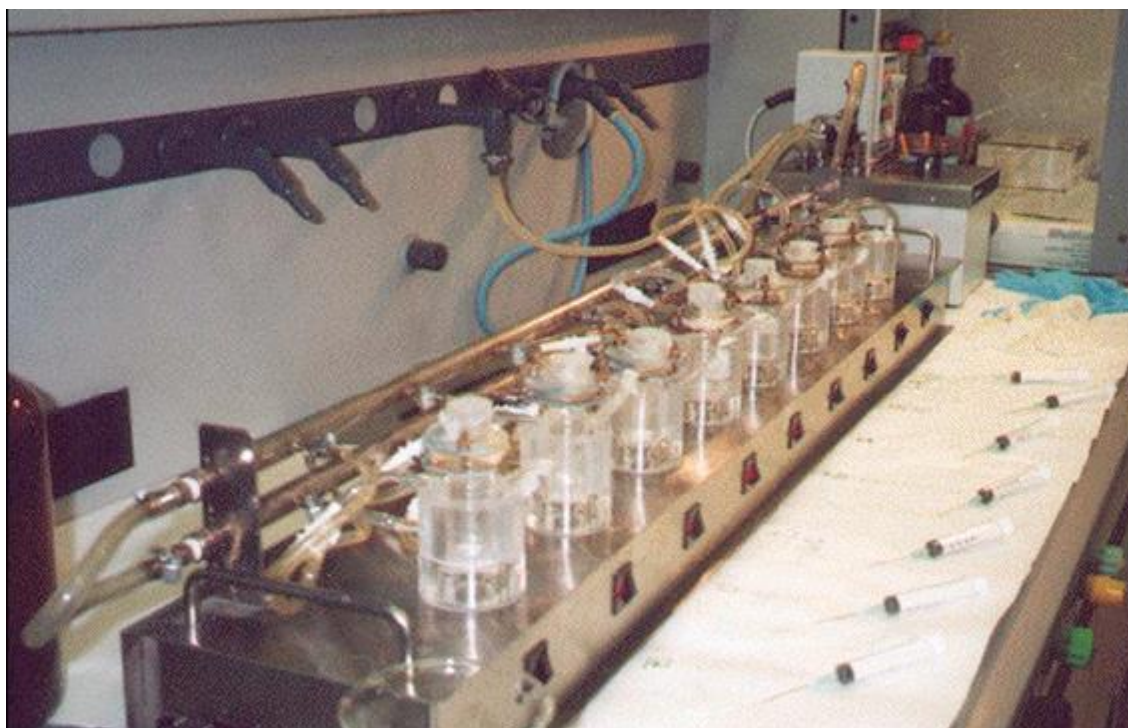
Fig.7 La consolle di lavoro e sistema di termostatazione delle celle di Franz.
