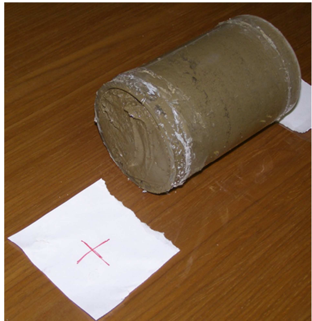
Foto 8. Maggiore consistenza del terreno catodico (a) rispetto a quello anodico (b) dopo il trattamento.
