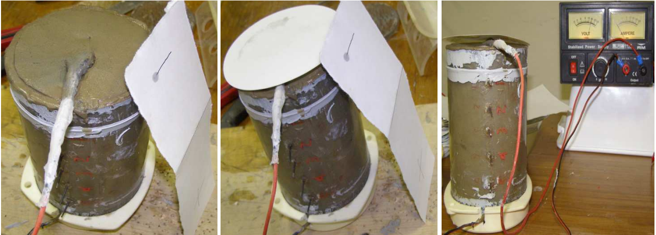
a b c Foto 21. Dewatering: a) posizionamento catodo; b) copertura parte catodica; c) durante il trattamento.
