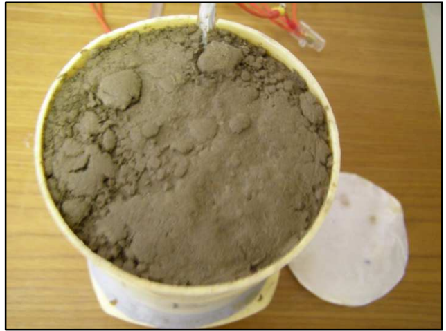
Foto 23. a) I campioni sottoposti a verifica di conducibilità. b) Il campione EO-60g-3V-15cm-B-promodello.
