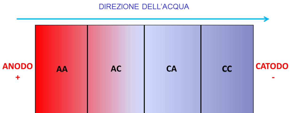
Figura 11. Suddivisione del campione al termine del trattamento.
