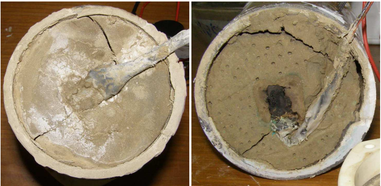
a b Foto 22. Termine dewatering: a) zona catodica; b) zona anodica.
