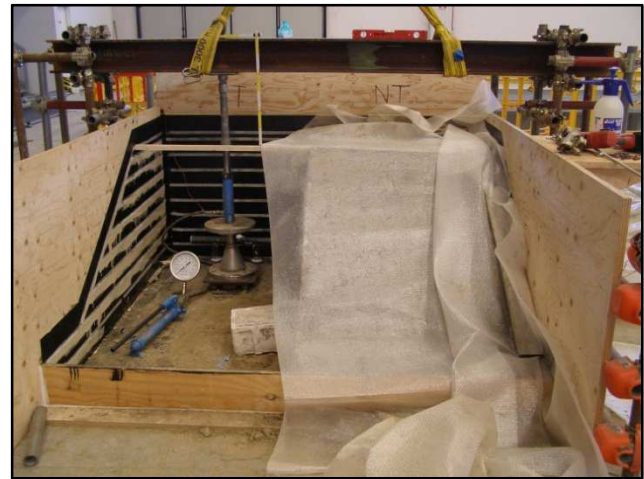
Foto 10. a) Terreno da utilizzare contenuto e coperto da teloni impermeabili; b) Modello fisico coperto in attesa del collasso.
