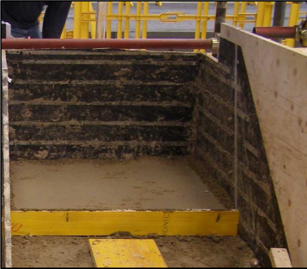
Foto 9. a) Costipazione del terreno sostenuto da centine; b) Sistema di carico del terreno.
