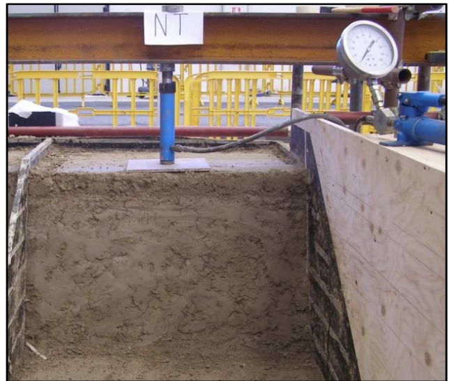
Foto 9. a) Costipazione del terreno sostenuto da centine; b) Sistema di carico del terreno.
