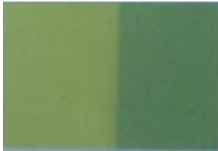
Figura 60: strip adesivo prima (sinistra) e dopo (destra) esposizione ai raggi UV
