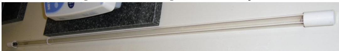
Figura 15: particolare relativo alla lampada a bassa pressione utilizzata nella campagna sperimentale
