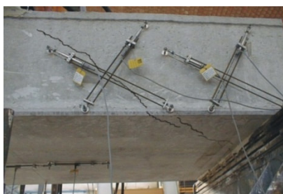
Figura 3.18 Fessura di taglio in corrispondenza del carico ultimo per il pannello a) H50-t1 e b) H50-t2.
