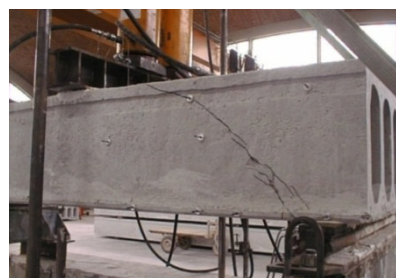
Figura 3.18 Fessura di taglio in corrispondenza del carico ultimo per il pannello a) H50-t1 e b) H50-t2.
