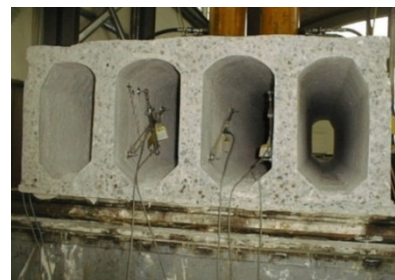
Figura 3.17 Particolare della disposizione degli estensimetri a) sulla superficie laterale del pannello e b) all'interno degli alveoli.
