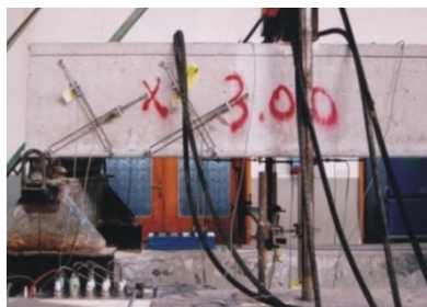
Figura 3.17 Particolare della disposizione degli estensimetri a) sulla superficie laterale del pannello e b) all'interno degli alveoli.
