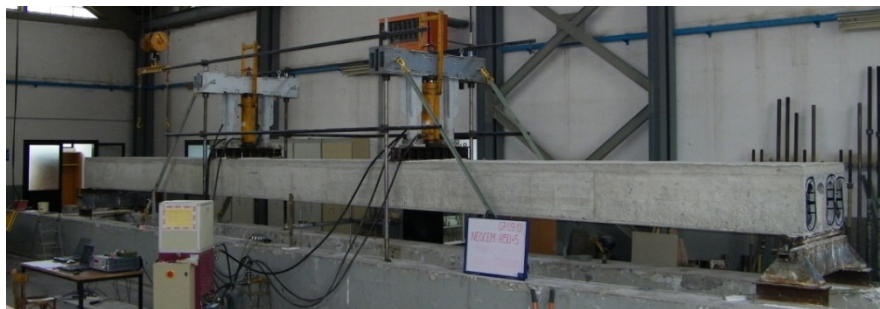
Figura 3.26 a) Schema di carico adottato nella prova sperimentale a flessione; b) configurazione reale di prova.
