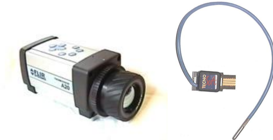
Figura 23: apparecchi utilizzati per la rilevazione delle temperature. A sinistra termo camera FLIR® A20, mentre a destra sonda TEMPSTICK® System.
