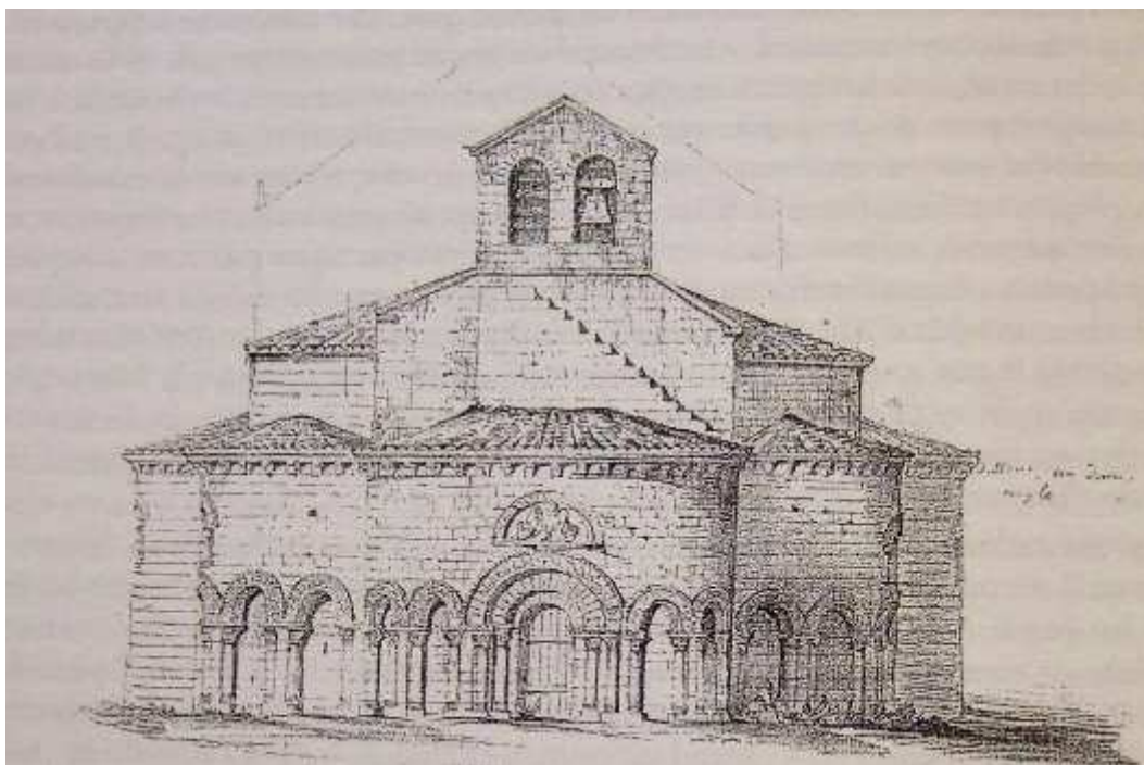
Fig. IV.6 Rilievo ante restauri della chiesa di Saint-Michel-d'Entraigues. In evidenza l'anomala collocazione della lunetta (da Congrès Archéologique de France. Charente ).
