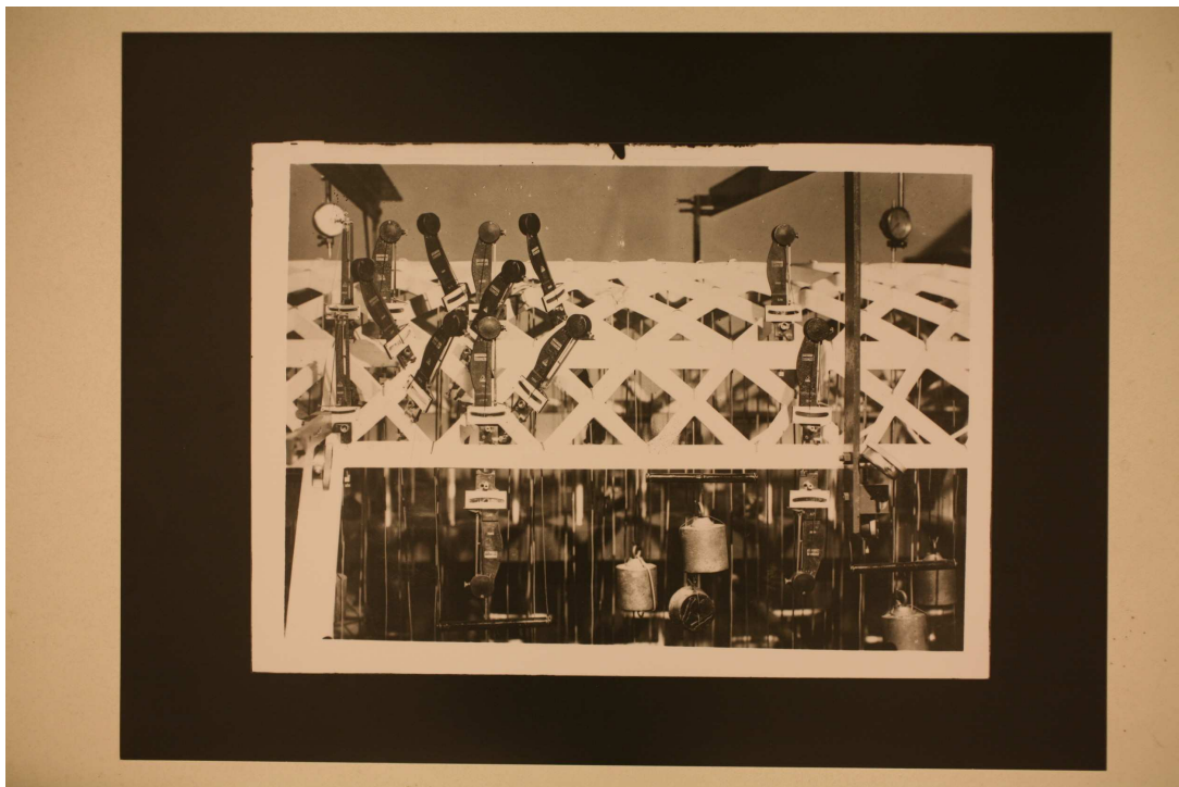
Fig. 7, Archivio Vasari, (Modello aviorimessa I tipo sottoposto a prove di carico), 1935, CSAC, sezione fotografia.
