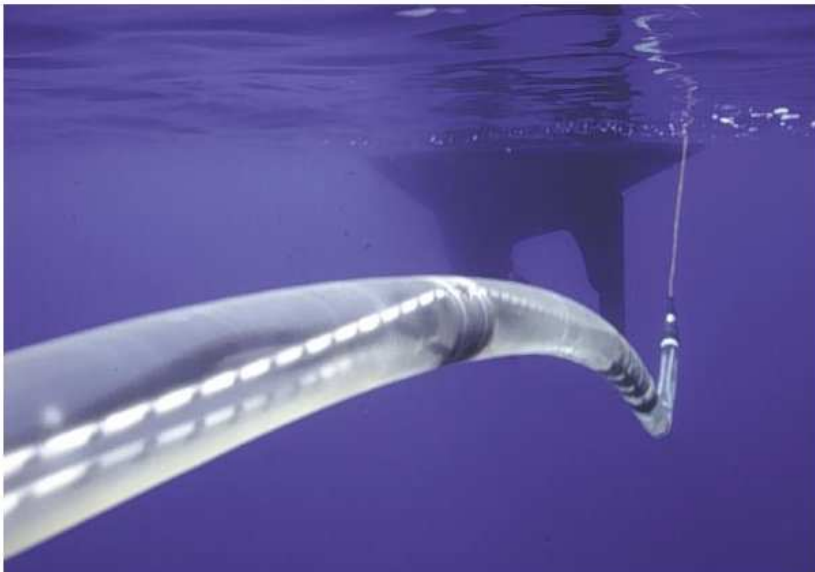
Fig. 12 Particolare dell' array Alenia al traino di una barca a vela (foto D.M. Rossi)
