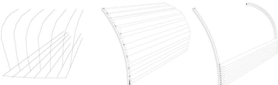
Fig. 4.30: Struttura di sostegno e controllo del meccanismo per un origami estensibile su superficie dotata di una singola curvatura.
