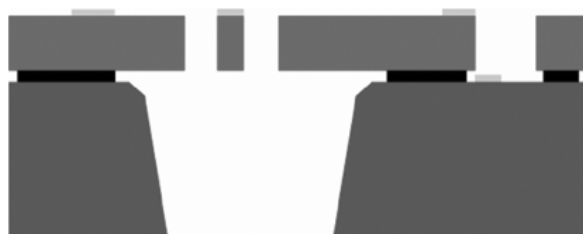
Figura 7.1: Schema della tecnologia SOIMUMPs
