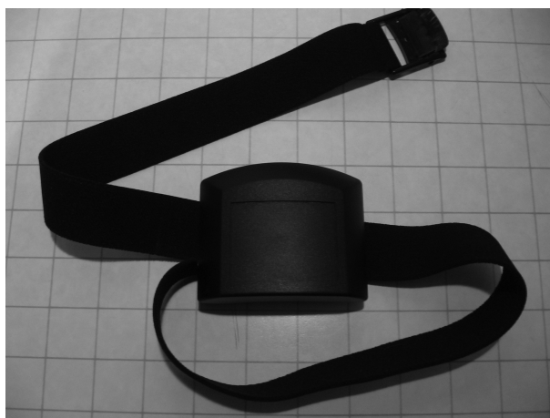
Figura 5.11: Immagine dell'involucro del PCB collegato ad una cintura
