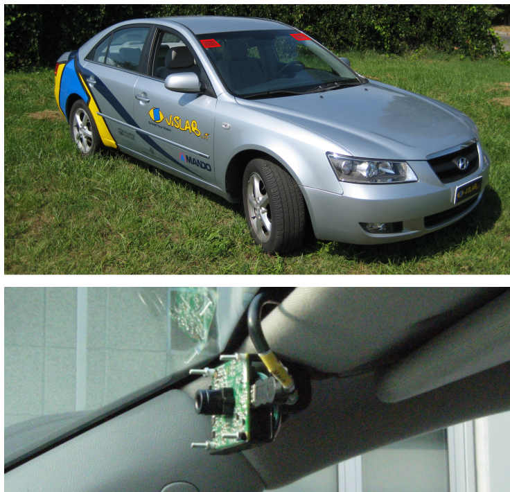
Figura 1.1: Il veicolo di test: in alto, evidenziato in rosso, il sistema di visione stereo montato sul parabrezza, sotto una vista ravvicinata della telecamera destra.
