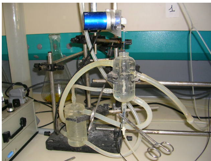
Figura 5 - Bagno per organo isolato.
