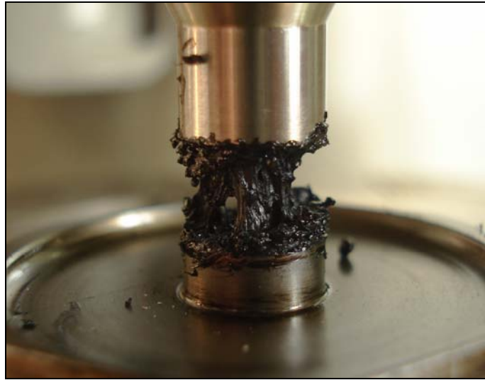
Figura 8.20. Provino di bitume N4-CRM20 a termine prova stress controlled.
