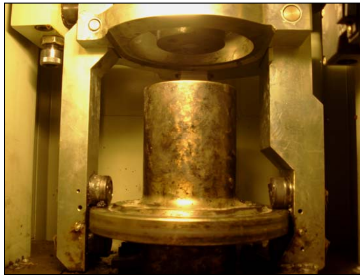
Figura 4.8. Pressa a taglio giratoria (sinistra) e particolare della cella di compattazione con fustella e testa da 100 mm (destra).
