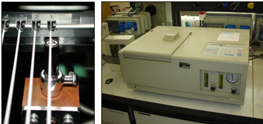
Figura 3.6. Iatroscan Analyzer MK-5 utilizzato per le analisi cromatografiche.
