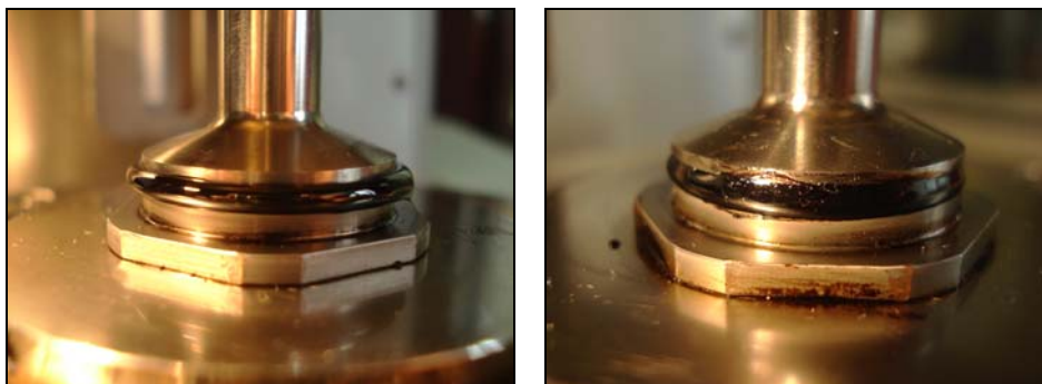
Figura 3.2. Provino in configurazione di prova precedentemente (sinistra) e successivamente (destra) alla rimozione del materiale in eccesso.
