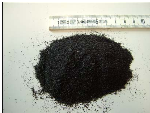
Figura 4.3. CRM utilizzato per la preparazione dei leganti modificati N4-16-CRM ed N4-20-CRM.
