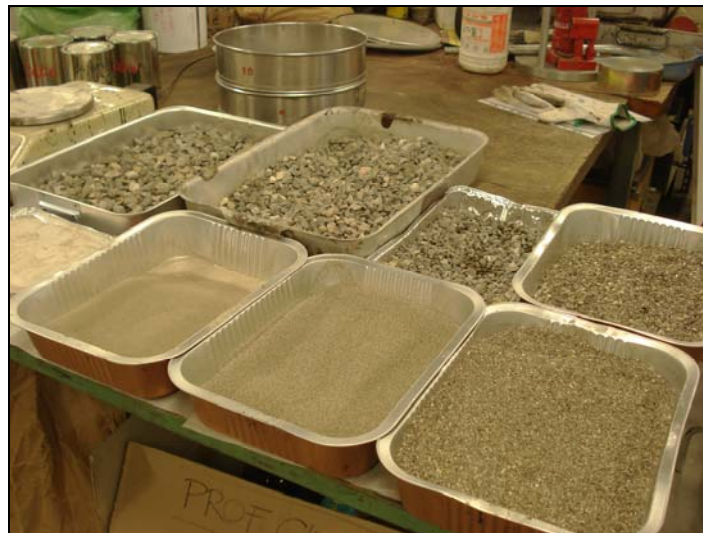
Figura 4.7. Formazione della miscela degli aggregati lapidei.
