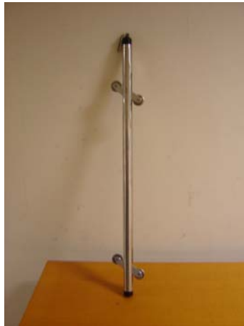
Fig.4.19-Sonda per rilievo misure inclinometriche
