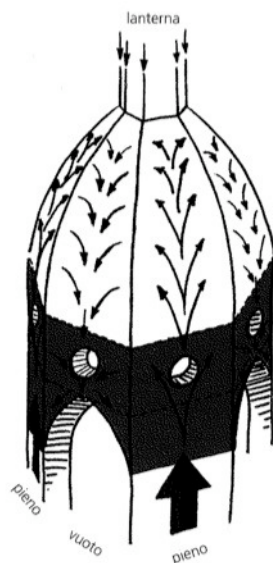
Figura 5.1.5. Rappresentazione schematica del flusso degli sforzi nel tamburo. xxxiii
