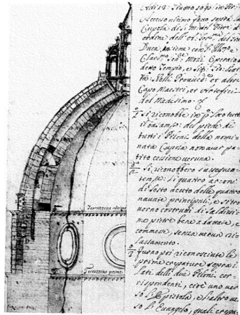
Figura 5.2.2. Rilievo di uno degli screpoli della Cupola da parte di Giovanni Nelli, 13 giugno 1690.
