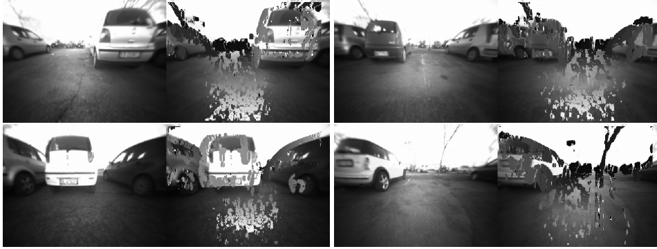
Figura 7.7: Disparità nel Lateral Motion Stereo : in scuro i punti a bassa e in chiaro i punti ad alta disparità
