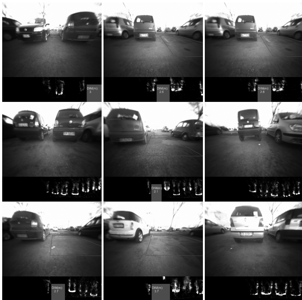
Figura 7.9: Esempio di individuazione ‘spazio libro’ basato su Lateral Motion Stereo
