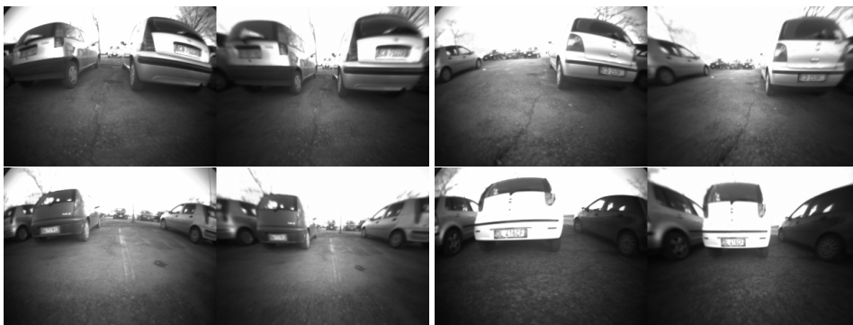
Figura 7.5: Rimozione della distorsione: a sinistra l'immagine acquisita e a destra l'immagine dedistorta
