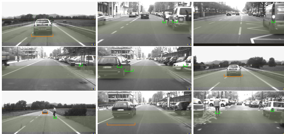
Figura 6.16: Alcuni risultati del sistema APALACI Motion Stereo : in verde i pedoni e in arancione i veicoli.
