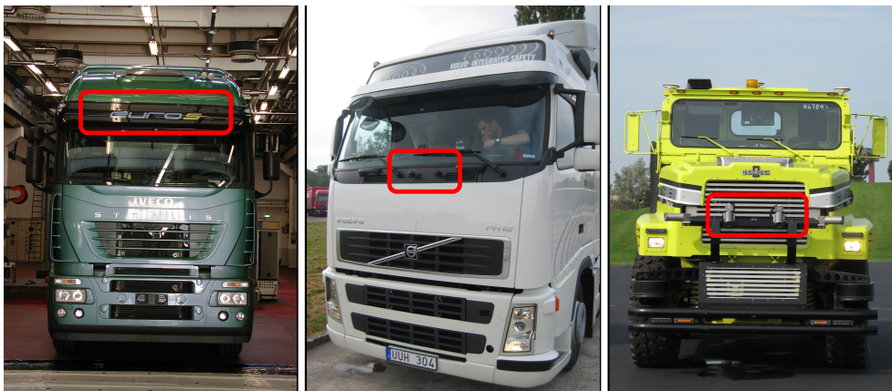
Figura 5.15: Esempi di installazioni del sistema Ground Plane Stereo IPM . Il riquadro rosso indica dove è stata installata la coppia di videocamere
